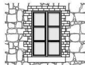
Encadrement de baie en briques
