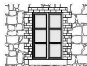
Encadrement de baie en briques
